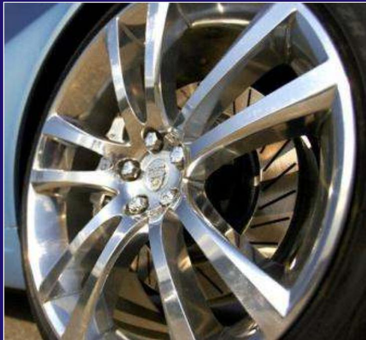
*Figura 1.* Copas de un auto cromadas. El cromado es un tipo de galvanizado o proceso de electrólisis mediante el cual se deposita cromo sobre un metal para darle más brillo y protección.
