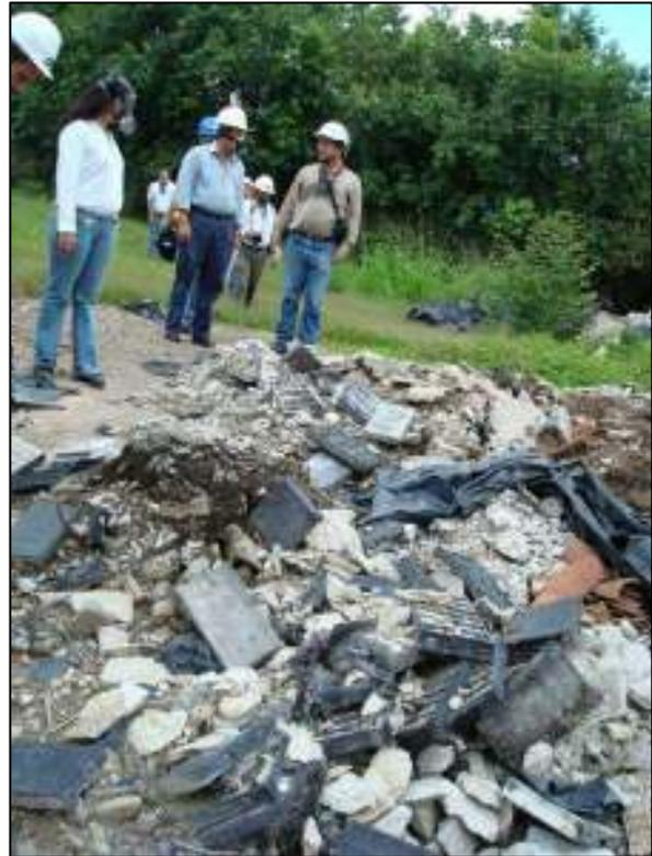
Figura 18. Restos de plomo desechados inadecuadamente en el Sitio del Niño por la compañía Baterías Record.
