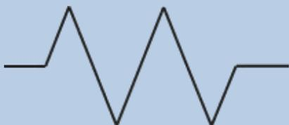
Figura 8. Representación de una resistencia eléctrica en diagramas de circuitos.
