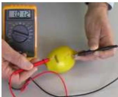
Insertar un centavo y un clavo galvanizado como muestra la figura, conectarlos directamente hacia un foco y probar si pueden encender el foco, si no se logra preguntar al estudiantado *¿Cómo lograr generar suficiente energía para encender el foco?* Dejar discutir la solución consiste en colocar en un circuito en serie de 2 o hasta 4 limones. Tal como muestra en la siguiente figura.
