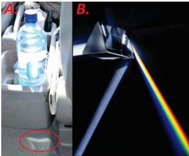
Figura 14. Luz blanca refractándose a través de una botella de agua y a través de un prisma, descomponiéndose en diferentes longitudes de onda.
