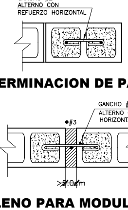
DETALLE TÍPICO DE ANCLAJES EN PAREDES FIGURA 5
