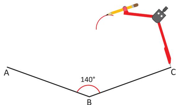
⑤ Copio la longitud del segmento AB y hago un trazo con el compás, con centro en A. Coloco D donde se cortan los trazos.
